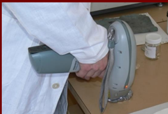
Přenosný XRF analyzátor NITON – prvková analýza materiálů
