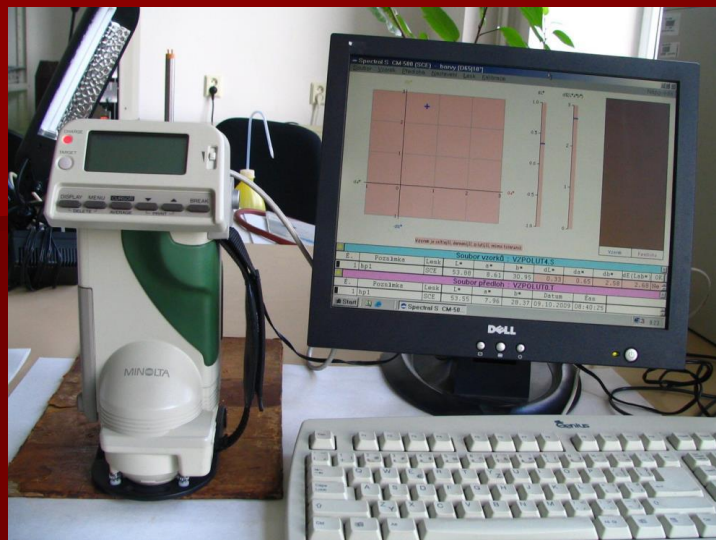
Spektrofotometr Minolta – měření barevnosti
