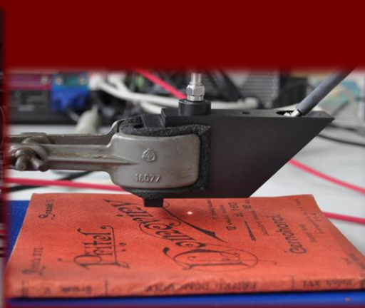
Měření teploty smrštění degradovaných usní mikroskopicky
